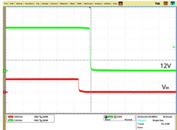
关机 ( $V_{in}=240V$  DC,  $V_{out}=12V$ )
