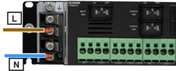
步骤 4 装回交流输入处的保护盖板。
